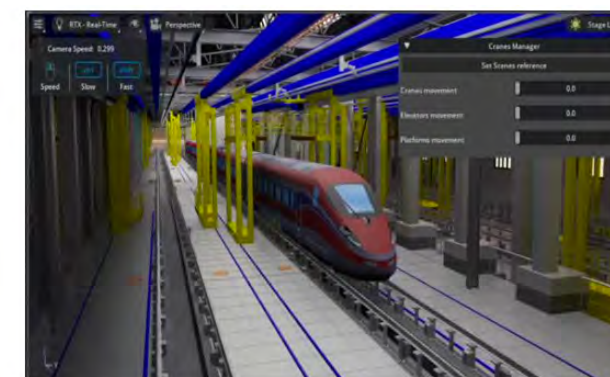
Figura 13 Esempio di simulazione della movimentazione del carroponte rispetto alla sagoma reale del treno sfruttando tecnologie Nvidia Omniverse (Fonte: Harpaceas)
